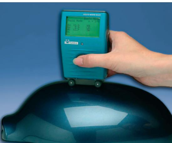
**Bild 4. Neues Messprinzip, bei dem jeglicher Einfluss der Messrichtung ausgeschlossen wird** (Foto: Byk-Gardner)
